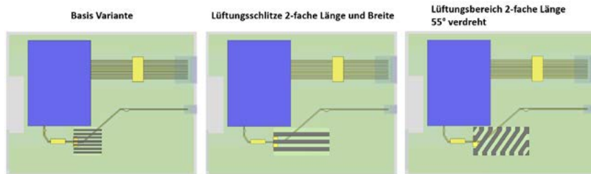
Abbildung 5: Größe und Ausrichtung des Lüftungsbereichs wird variiert, um Lösungsansätze zu finden.
